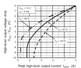
Fig. 13.2.10 (V<sub>OH</sub>-V<sub>CC</sub>) - I<sub>OPH</sub>
