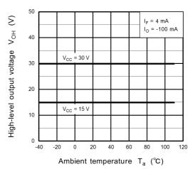
Fig. 13.2.8 V<sub>OH</sub> - T<sub>a</sub>
