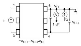
Fig. 13.1.3 V<sub>OH</sub> Test Circuit
