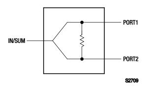
Figure 1. PD18-73/PD18-73LF Block Diagram
