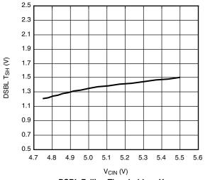
DSBL Falling Threshold vs.  $V_{\rm CIN}$
